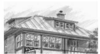
Toiture recouverte de tôle à baguette
