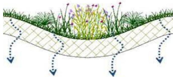
L'eau de ruissellement passe par une bande filtrante (pierres), pour ensuite se jeter dans le jardin de pluie et s'infiltrer dans le sol.
